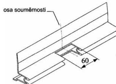
Obr. 2 Výřez profilu
